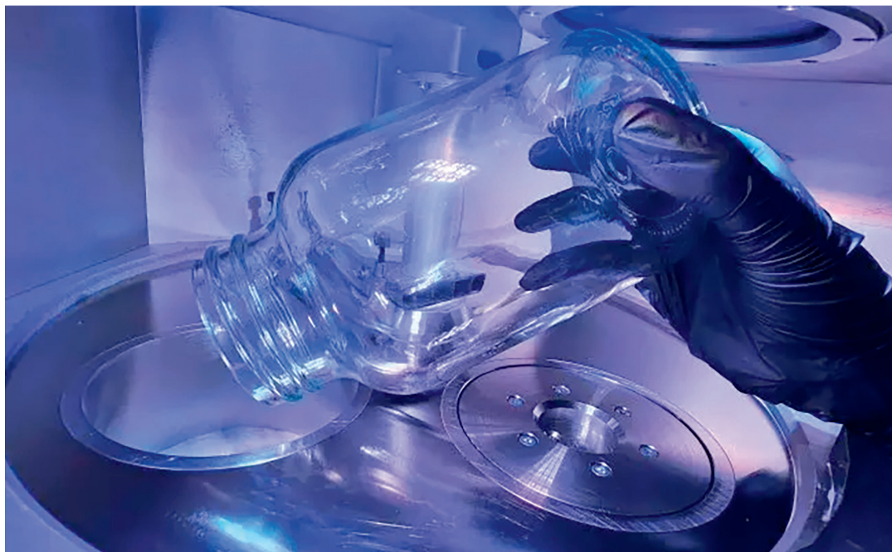
► Beholdersystemet for sikker og støvfattig håndtering av metallpulver.
